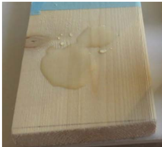
撥水効果はⅠ型に比較してあまり大きくないが、表面は元表面の状態と同じ。
