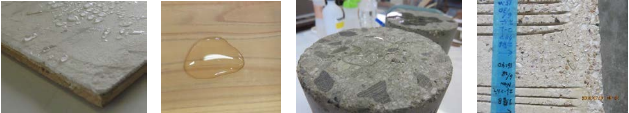
①マグ塗り壁上面 ②杉板表面 ③コンクリート表面 ④かきがらブロック 写真1 マグ表面保護撥水剤(撥水ⅠW型と撥水ⅡS型)の撥水効果
