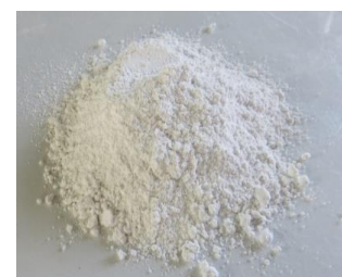
写真 1 マグエン：海由来の自然素材を主体とした水硬性の粉状バインダー。各種の材料とコラボして混ぜると色々な粉状の造形材をつくることができます。そして水を加えてスラリー、固化すると多種多様な造形体を形成
