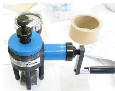
写真7-1 付着引張り試験機
